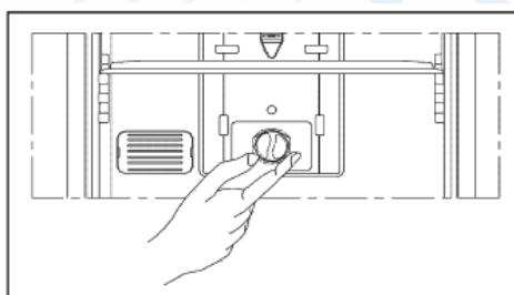
Термостат автоматически регулирует температуру внутри холодильной и морозильной камер. Путем изменения позиции ручки с MIN («1») на MAX («6») может быть достигнута более низкая температура.
